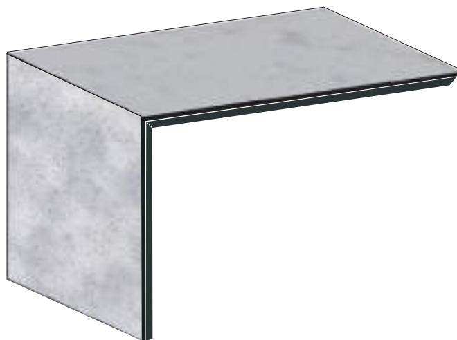
2. Taglio a 45° per montaggio a L*
